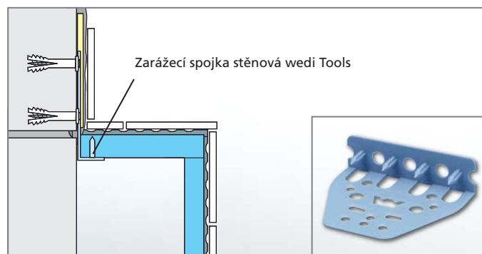
Upevnění konstrukce ze stavební desky na stěnu.
